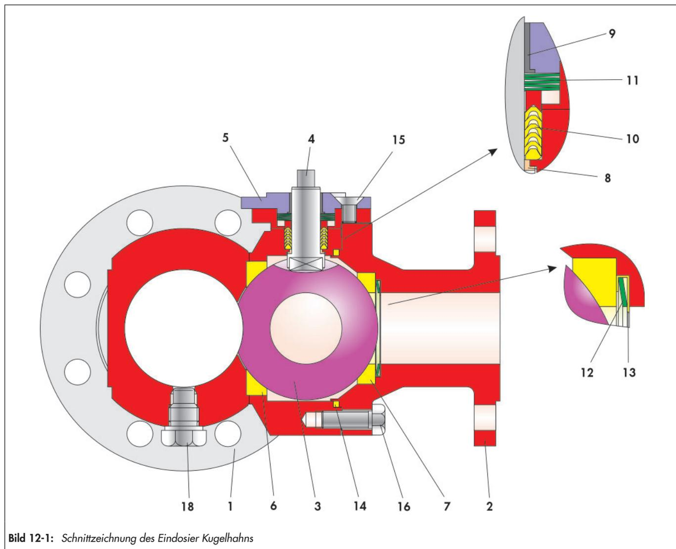
Bild 12-1: Schnittzeichnung des Eidosier Kugelhahns
